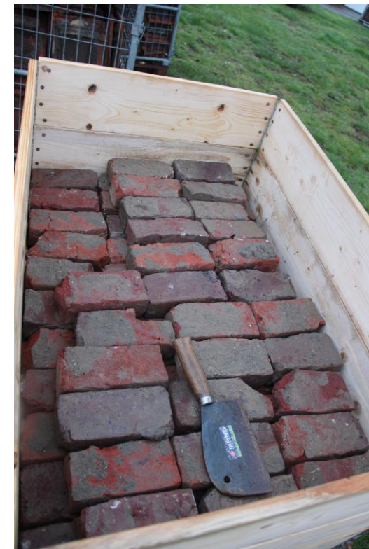
Opslag en nazicht van bakstenen in kisten
