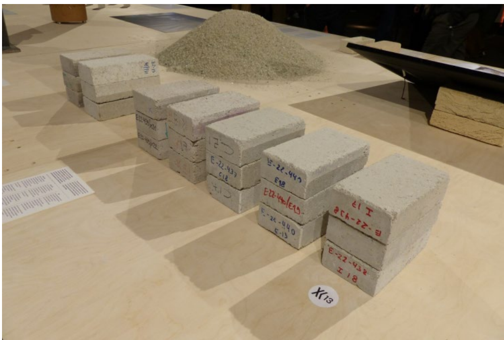
Figuur 7: Ontwikkeling van circulaire gevelsteen voor het DING Museum te Gent. Om de kwaliteit van deze experimentele steen te waarborgen en de gebruiksgeschiktheid ervan te onderbouwen, doorloopt de opdrachtgever een intensief traject met BCCA. Door een goede onderbouwing van de technische prestaties van de steen en de juiste ontwerpmaatregelen worden de risico's zo veel mogelijk genormaliseerd. Bron foto: faro.be
